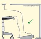
Wir empfehlen die Verwendung einer Fußstütze, die mindestens 45 cm breit und 35 cm tief ist. Der Höhenverstellbereich sollte vom Boden aus mindestens 11 cm betragen. Der Neigungswinkel der Stützfläche sollte von 5° bis mindestens 15° verstellbar sein.
